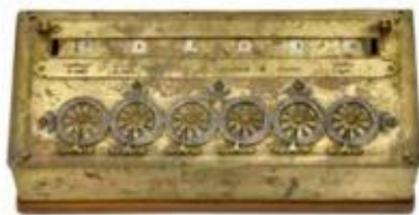
Hình 1.3. Chiếc máy tính cơ khí đầu tiên "Pascaline"
